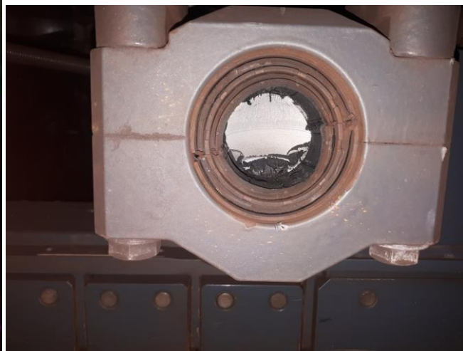
Figura 1. Parte din ansamblul antirului rupt al semitrenului 1320 (capătul de bară rămas fixat în zona articulației de fixare)
